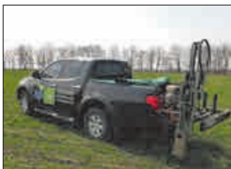
94. ábra Vegyi talajelemző az autó platóján
