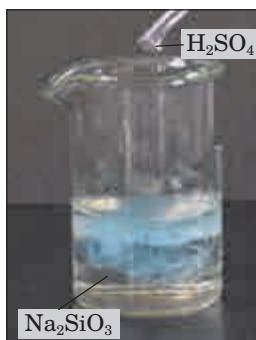
90. ábra Kovasav csapadékának kialakulása
