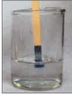
16. ábra Az univerzális indikátor- papír színének vál- tozása a nátrium- karbonát vizes oldatában
