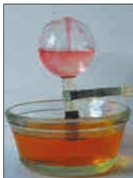
42. ábra A hidrogén-klorid oldódása vízben (szökőkút-kísélet)
