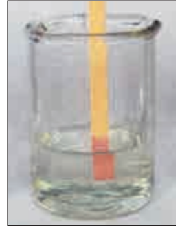
17. ábra Az univerzális indikátor- papír színének vál- tozása az ammónium- klorid vizes oldatában
