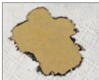
Fig. 65. Rezultatul căderii pe șervețel a acidului sulfatic concentrat
