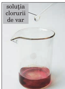
Fig. 74. Reacția anilinei cu clorura de var
