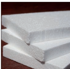
Fig. 86. Blocuri din masă plastică expandată pentru izolarea caselor
