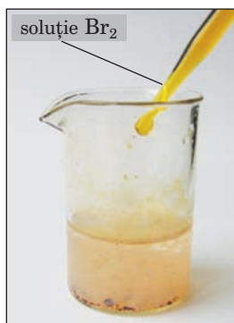
Fig. 73. Reacția anilinei cu apa de brom
