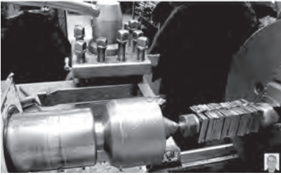
Рис. 11.6. Встановлення пакету в патроні та задньому обертовому центрі
