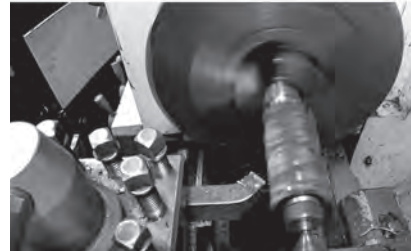
Рис. 11.7. Обробка зовнішнього діаметра пакету заготовок з тонколистової сталі
