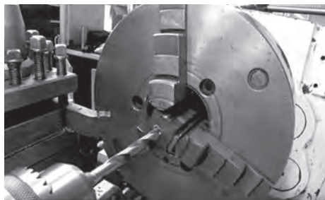
Рис. 11.3. Свердління отвору в сталевому пакеті
