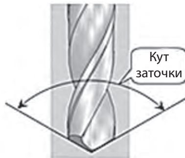
Рис. 4.7. Кут заточки свердла
