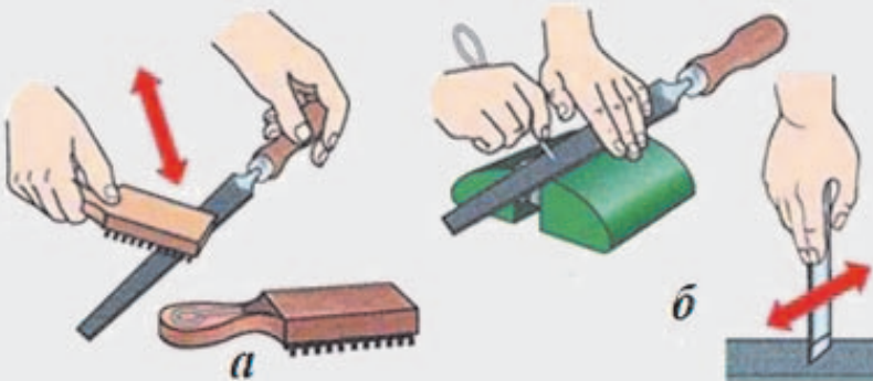
Рис. 1.5.13. Очищення насічки напилків: а — кордовою щіткою; б — скребком з м'якого металу
