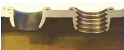
Рис. 5.1.3. Приклад різьбового отвору
