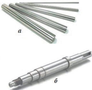
Рис. 2.2.21. Прямі вали: а — гладкі; б — ступеневі
