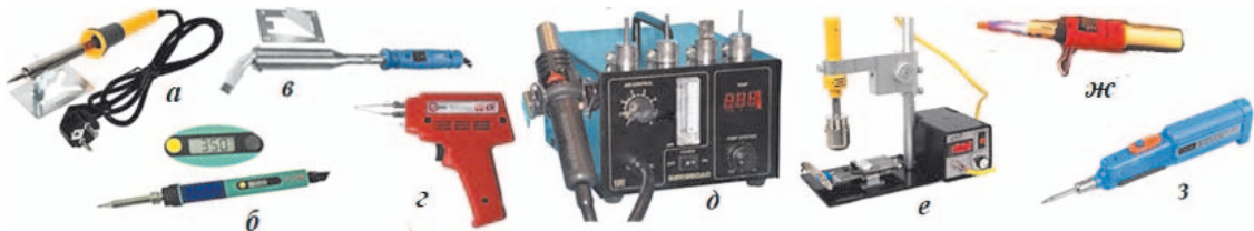
Рис. 1.9.2. Різновиди паяльників: а – класичний електричний; б – цифровий; в – для паяння і лудіння металевих деталей; г – імпульсний; д – термоповітряна паяльна станція; е – інфрачервона паяльна станція; ж – газовий; з – автономний акумуляторний
