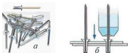
Рис. 1.8.13. Витяжні заклепки (а) та схема монтажу витяжної заклепки (б)
