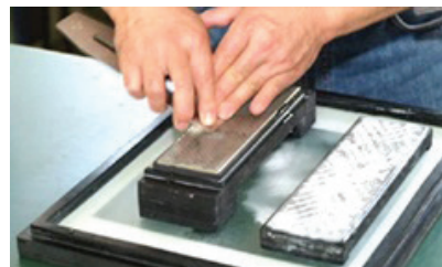
Рис. 1.10.5. Доведення леза рубанка на притирочних брусках
