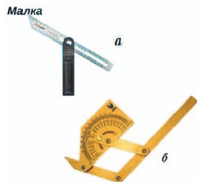
Рис. 3.5.7. Малки: а — проста; б — подвійна
