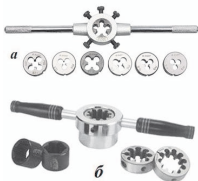
Рис. 1.7.11. Типи круглих плашок: а — цільні; б — розрізні
