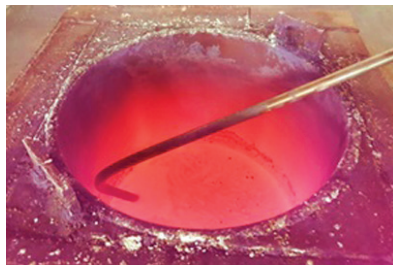
Рис. 4.8.15. Загартування з нагріванням в соляній печі-ванні
