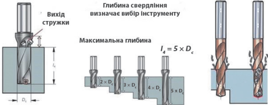
Рис. 1.6.8. Вибір інструменту при свердлінні на глибину
