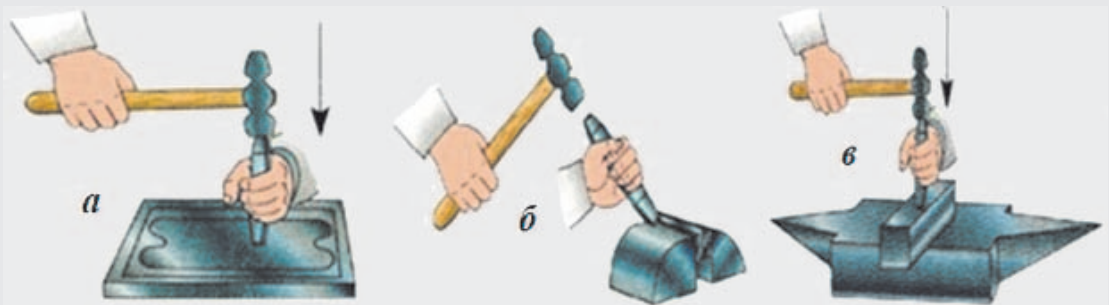
Рис. 1.2.2. Рубання металу: а — на плиті; б — у лещатах; в — на ковадлі
