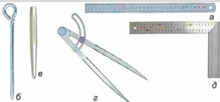
Рис. 1.1.4. Розмічальні слюсарні інструменти: а — масштабна лінійка; б — рисувалка; в — кернер; г — слюсарний циркуль; д — кутник
