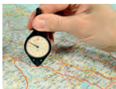
Mierzenie linii krzywych na mapie za pomocą kurwimetra
