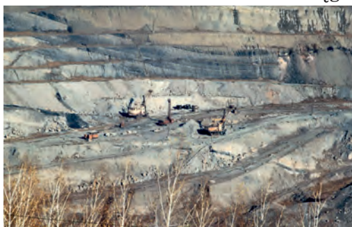
Rys. 75. Wydobycie węgla brunatnego sposobem odkrywkowym (Złoże Aleksandryjskie w obwodzie kirowogradzkim)
