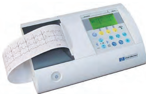
Ryc. 26. Elektrocardiograf Elektrocardiograf i otrzymane za jego pomocą wskaźniki czynności serca (elektrocardiogram)
