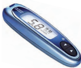
Ryc. 24. Glukometr – przyrząd do pomiaru zawartości poziomu glukozy we krwi
